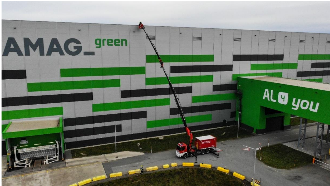
Bild 1: Der Kranwagen der AMAG Betriebsfeuerwehr erreicht das Dach des Walzbarren-Hochregallagers mit einer Höhe von ca. 33 Metern. (@AMAG)
