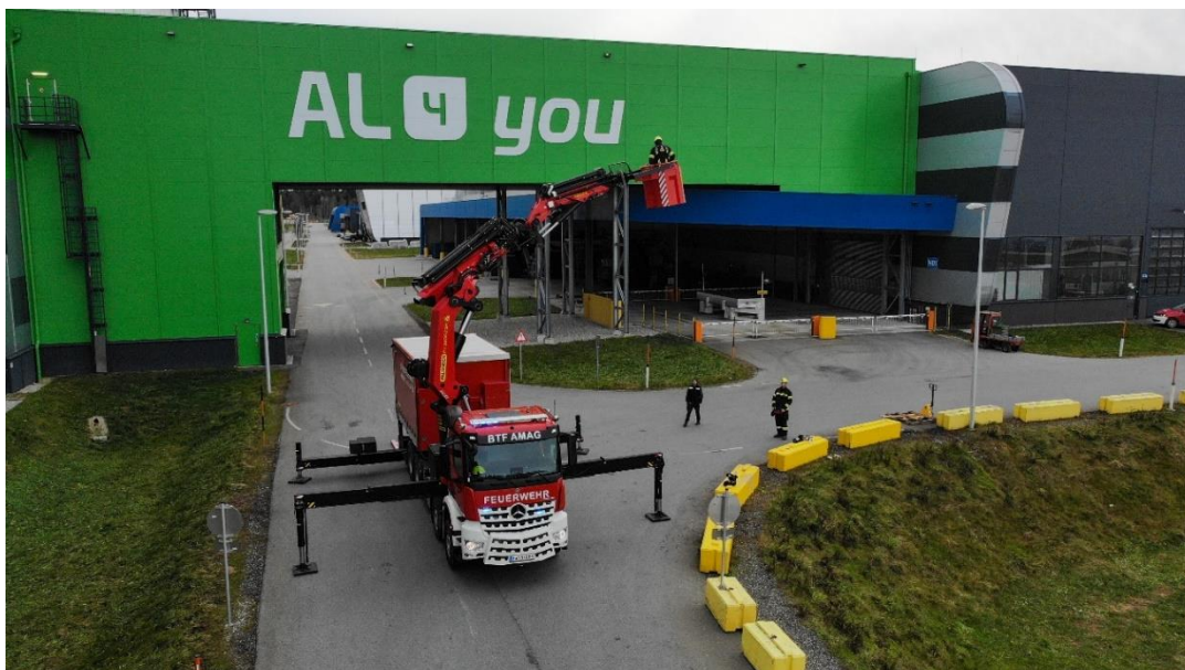
Bild 2: Der Kranwagen ist für technische Einsätze in großen Höhen vorgesehen und wird zum Bewegen von schweren Lasten eingesetzt. (@AMAG)
