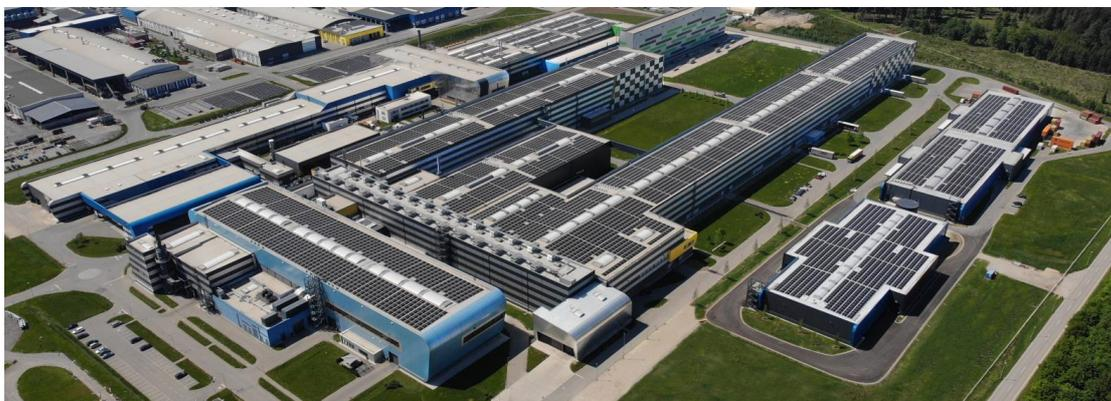
Bild 2: 60.000 m<sup>2</sup> Photovoltaikanlage auf den Dächern des neuen AMAG Werks produzieren 7,3 GWh elektrischen Strom pro Jahr (© AMAG)
