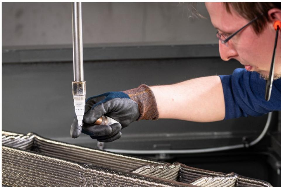
*Bild 2: Flugzeugkomponente aus Titan gefertigt durch Auftragsschweißen (© AMAG)*
