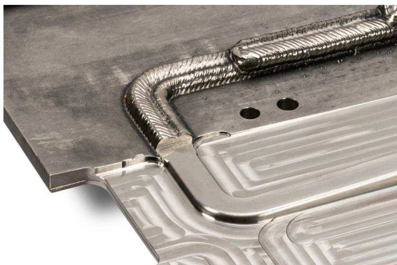
*Bild 3: Flugzeugkomponente aus Titan – im Bild oben Rohzustand nach dem Schweißen, unten nach der mechanischen Bearbeitung (© AMAG)*
