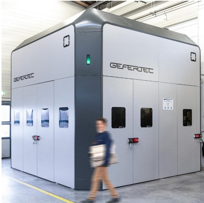
*Bild 4: Die hochmoderne Anlage zur additiven Fertigung von Bauteilen aus Titan (© AMAG)*
